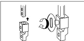
Coloque el adaptador de prensatelas.
