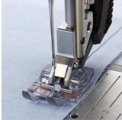
Der durchsichtige 1/4" Quilt und Patchworkfuß eignet sich besonders gut zum Zusammennähen von Stoffstücken, da er beim Nähen von 1/4"-, 1/8"- und 3/8"-Nähten beste Sicht bietet. Die roten Linien am Nähfuß kennzeichnen 1/4"-Drehpunkte vor und hinter der Nadel.
