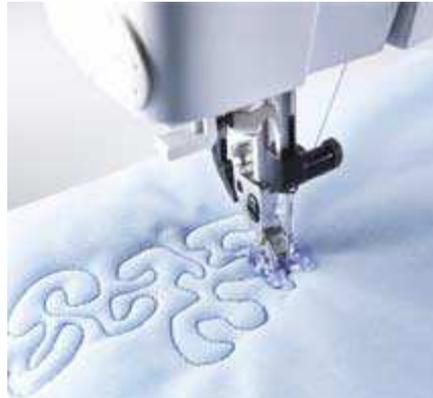
Der Offene Sensormatik-Freihandfuß eignet sich perfekt für fantasievolles Freihandnähen und -sticken. Er bietet optimale Sicht durch seine weite Öffnung und den waagerechten und senkrechten Markierungen.
