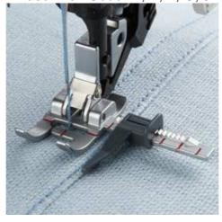
Der Nähfuß mit variabler Führung für IDT-SYSTEM sorgt für die perfekte Führung beim Absteppen und Nähen mit Zierstichen. Am Nähfuß sitzt ein "Lineal" mit einer verstellbaren Führung, die Sie an einer beliebigen Linie anlegen können. Sie können die Führung an einer Naht oder der Stoffkante anlegen und erhalten so eine perfekte Absteppnaht. Der Nähfuß eignet sich sowohl für Geradstich als auch für Zierstiche. Der Fuß ist geradezu perfekt für parallele Quiltlinien.
