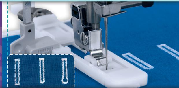
**Knopflöcher:** Es stehen 8 Knopflochmuster zur Wahl. Die Maschine näht automatisch Knopflöcher entsprechend der Knopfgröße. Bei Nähende hält die Maschine automatisch nach dem Verriegeln an. Je nach Nähprojekt können auf allen Stoffen ganz einfach dünne bis dicke Knopflöcher genäht werden.
