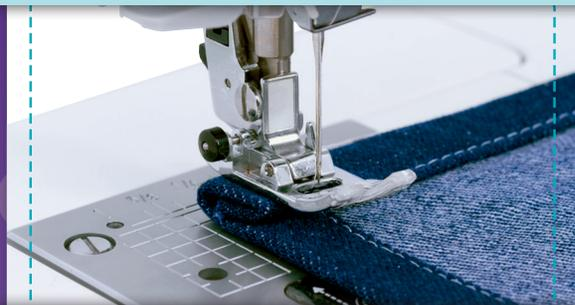
**Einfacher Nähbeginn:** Den Knopf am Nähfuß drücken und den Fuß parallel zur Stichplatte bringen. Dies ermöglicht einen einfachen Nähbeginn bei mehreren Stofflagen oder überlappenden Materialien und schweren Stoffen.
