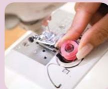
Volle Spule einlegen, Faden in Pfeilrichtung legen und es kann losgehen.
